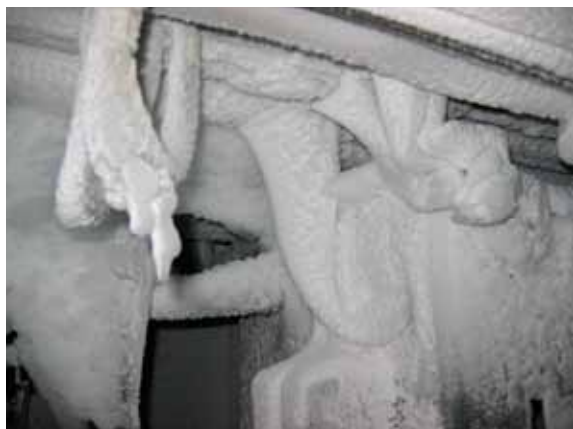
Abb. 5: Auch bei –55 °C eine einwandfreie Druckluftherzeugung; Test in der Klimakammer
