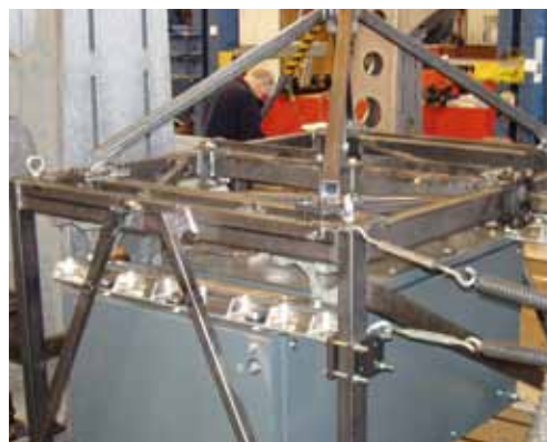
Abb. 6: Der langwierige Weg zur IRIS-Zertifizierung: Rüttel- und Vibrationstest
