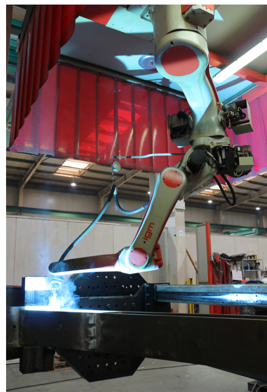
Dazu setzt der Lohnfertiger auf das Roboterschweißen.
