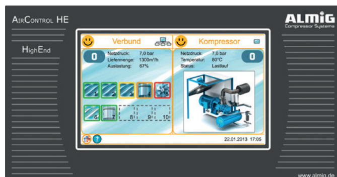
Die Steuerung ALMiG Air Control HE regelt jeweils zwei Kompressoren im Verbund. Damit lassen sich die Energievorteile der Drehzahlregelung voll nutzen.
