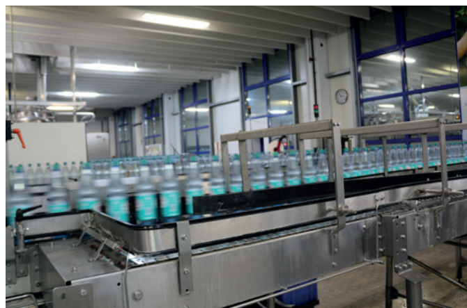
Die Förderanlagen transportieren die PET-Flaschen kontrolliert zu den Stationen wie Befüllung und Etikettierung.
